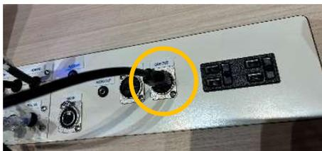
【CAM OUT】に HDMI ケーブル側を接続
